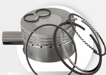
KPS077 KIT PISTÓN (+ AROS) MEDIDA 0.25 KPS092 KIT PISTÓN (+ AROS) MEDIDA 0.75 BIT 110CC
