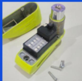
**2** CON LA TRABA EN POSICION VERTICAL, LEVANTAR EL CONTENEDOR DE PILAS.
